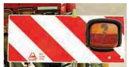
Markierungstafel mit Beleuchtungsvorrichtungen
