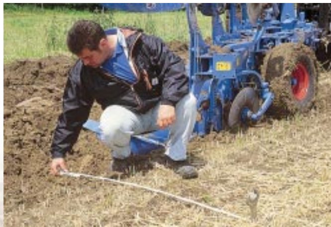
Durch Zurückmessen wird geprüft, ob die Vorderfurchenbreite passt.
