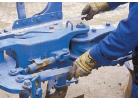
Das äußere Spannschloss wird auf die ungefähre Hauptlenkerlänge eingestellt. Als Grobeinstellung reicht die erst mal.
