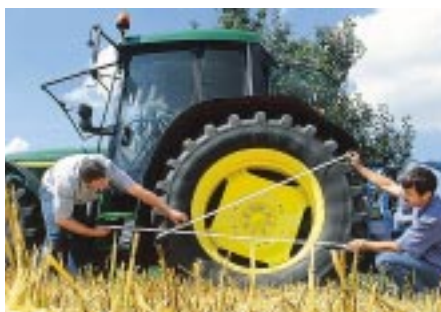
Falsch: Die verlängerten Linien von Ober- und Unterlenker treffen sich zu weit hinten. Besonders bei Allradtraktoren wird unnötiges Zugpotential verschenkt, da die Vorderachse nicht genug Gewicht bekommt.
