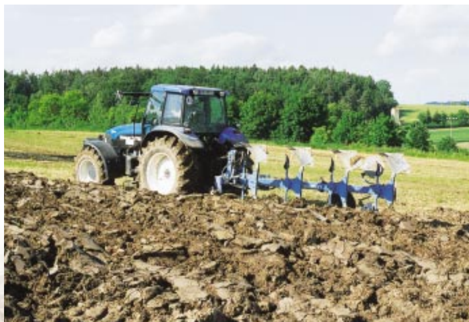
Beim Anpflügen wird der Oberlenker ausgehängt. Fahren Sie ruhig etwas schneller, damit sich kein Erdwall bildet.
