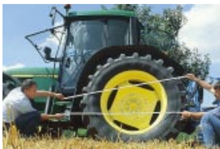
Oben: Richtige Einstellung. Beide Linien treffen sich kurz vor der Vorderachse.
