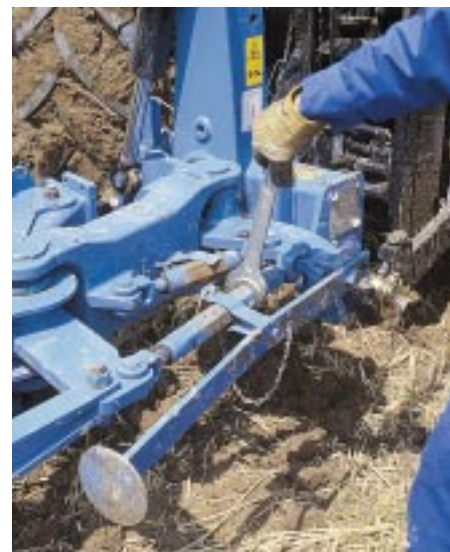
Am Optiquick-Einstellcenter wird die Vorderfurchenbreite verändert.
