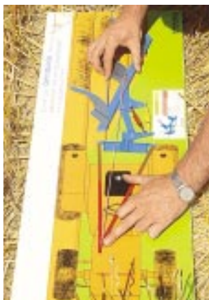
Seitenzug in Fahrtrichtung nach rechts! Der Schlepper drängt aus der Furche der Fahrer muss ständig gegenlenken. So macht die Arbeit keinen Spass.
