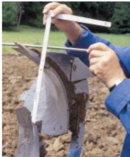
Wenn der Vorschäler zu tief arbeitet, erhöht sich die Zugkraft.
