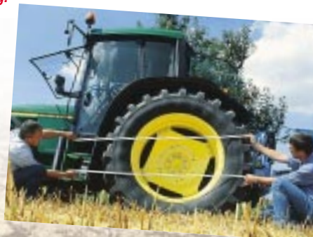
Rechts: Falsch! Die Zuglinien treffen sich gar nicht. Das Gespann läuft unruhig und lässt sich schlecht lenken.
