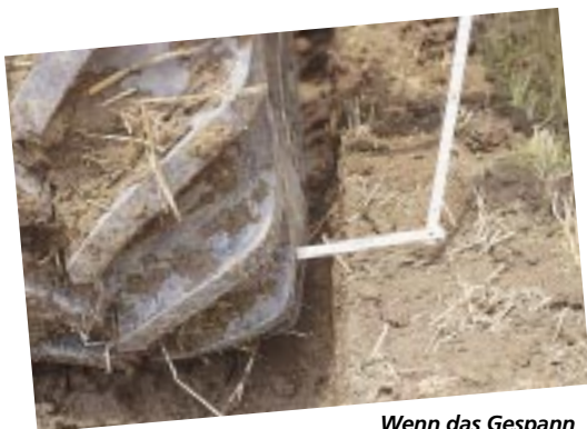
Wenn das Gespann geradeaus läuft, ist das Vorderrad einige Zentimeter von der Furchenkante entfernt – und dies ohne dass der Fahrer gegenlenken muss.
