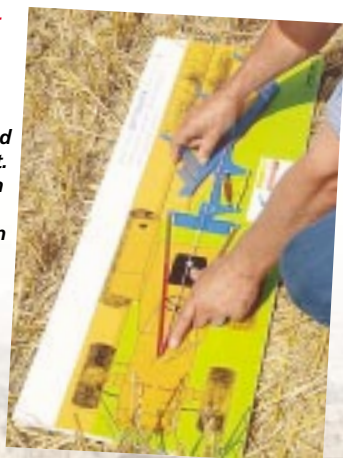
Seitenzug in Fahrtrichtung nach rechts! Der Schlepper drängt aus der Furche der Fahrer muss ständig gegenlenken. So macht die Arbeit keinen Spass.
