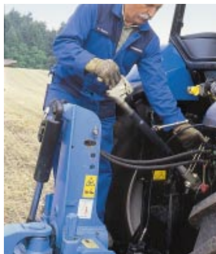
Beim Anpflügen wird der Oberlenker ausgehängt. Fahren Sie ruhig etwas schneller, damit sich kein Erdwall bildet.
