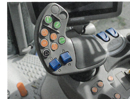
Angenehm in der Hand liegt der Joystick, über den sämtliche Funktionen geschaltet werden.
