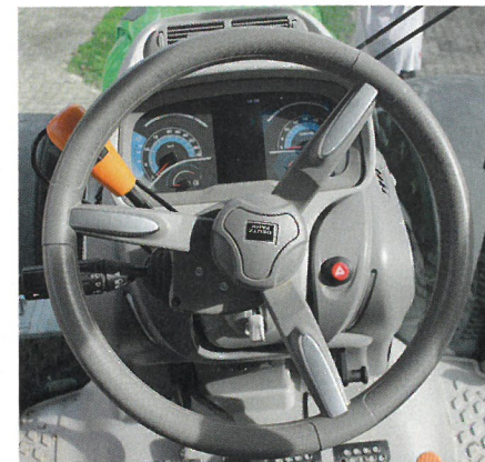
In der Konsole sorgt das Fünf-Zoll-LCD-Display für eine optimale Übersicht aller wichtigen Funktionen wie Getriebe und Hydraulik.
