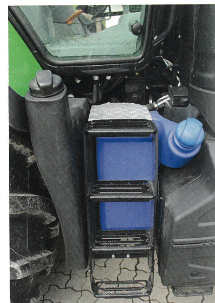
Der AdBlue-Tank fasst 35 Liter. Der 280 Liter beinhaltende Dieseltank ist beidseitig befüllbar.
