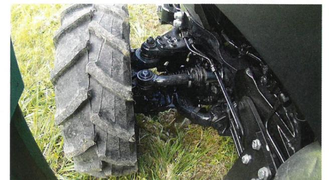
Optional gibt es eine gefederte Vorderachse mit elektronisch gesteuerter Einzelradaufhängung.
