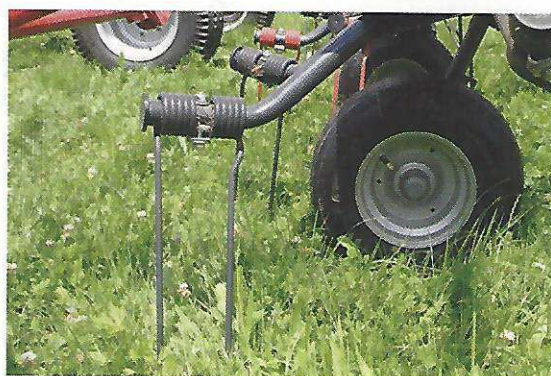
Rundrohrträger mit ungleichschenkeligen Doppelzinken und Zinkenverlustsicherung.
