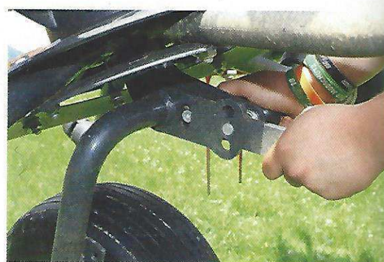
Dreistufige Kreiselneigungsverstellung mit Schnellverschluss.
