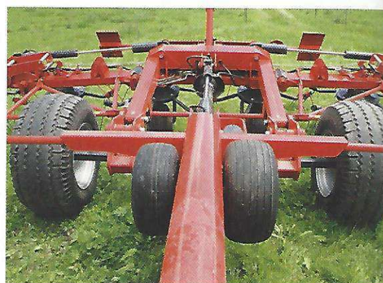
Die lange Deichsel mit der weit hinten positionierten Achse erleichtert das Rückwärtsfahren und schafft Freiraum für Zwillingssäder.
