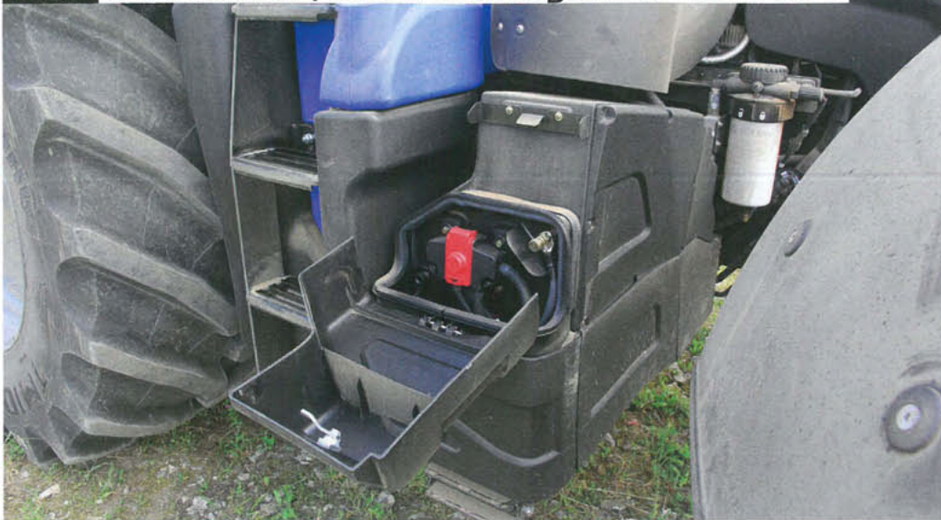
Rechts sind neben dem AdBlue-Einfüllstutzen und dem zweiten Diesel-Einfüllstutzen Klemmpole im Batteriekasten zugänglich.
