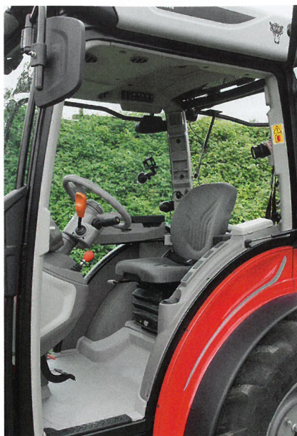
Vor allem die großen Türen, der ebene Boden und die hochgezogene Front- und Heckscheibe zeichnen die neue Vier-Pfosten-Kabine aus.
