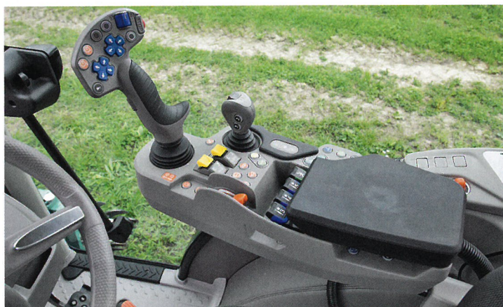
Über die MaxCom-Multifunktionsarmlehne lassen sich alle wichtigen Funktionen bedienen. Zukünftig soll ein Terminal integriert werden.
