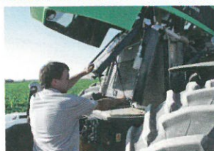
Die Motorhaube der Serie 9 wird per Tastendruck geöffnet und geschlossen. Zusätzliche Dämpfer oder eine Leine werden nicht gebraucht. Die dafür notwendigen Schalter lassen sich in einem Kästchen abschließen und im Falle eines Batterieproblems überbrücken. Das Kühlerpaket ist groß dimensioniert und doppelt klappbar.
