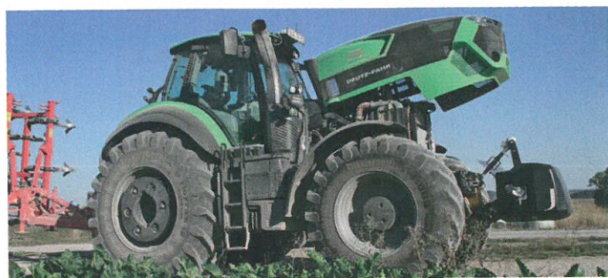
Die Motorhaube der Serie 9 wird per Tastendruck geöffnet und geschlossen. Zusätzliche Dämpfer oder eine Leine werden nicht gebraucht. Die dafür notwendigen Schalter lassen sich in einem Kästchen abschließen und im Falle eines Batterieproblems überbrücken. Das Kühlerpaket ist groß dimensioniert und doppelt klappbar.
