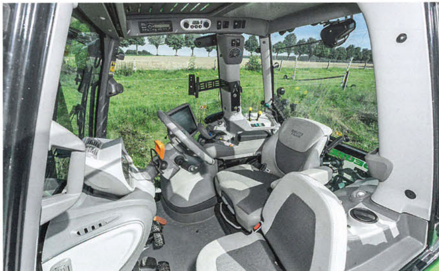
Mit 74 dB(A) leise: die Kabine des 6185 RCshift. Nur der Sitz lässt sich nicht seitlich drehen, und der Bezug ist zu empfindlich.
