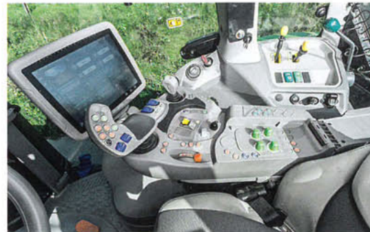
Die Bedienarmlehne samt Multifunktionsgriff gefällt uns sehr gut. Der Knopf für die Getriebeautomatik sitzt allerdings unter der Abdeckung.
