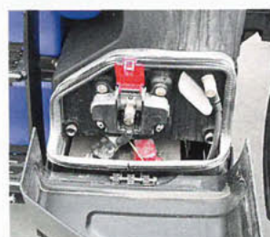
Externe Batterie-Pole erleichtern die Starthilfe.
