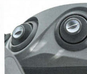
Die Luftdüsen sind noch immer nicht dicht zu schließen.
