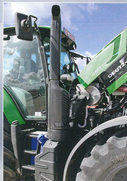
Hinten unter der Haube der Dieselpartikelfilter, unten im Auspuff der SCR-Kat. AdBlue tanken geht nach wie vor nur rechts, Diesel auf beiden Seiten.
