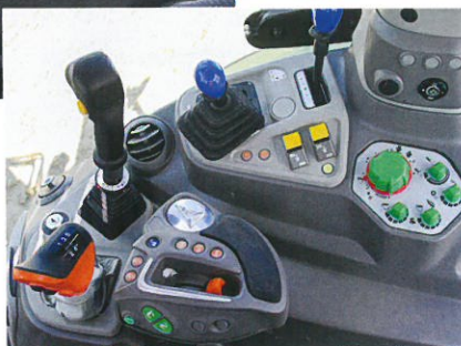
Die „Powershift“-Variante hat noch einen Ganghebel und eine neu gestaltete Konsole.
