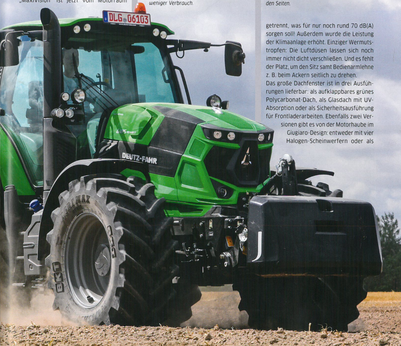
Das Kühlerpaket ist komplett überarbeitet und der Viscolüfter jetzt elektronisch geregelt. Deutz-Fahr verspricht mindestens 5 % weniger Verbrauch.
