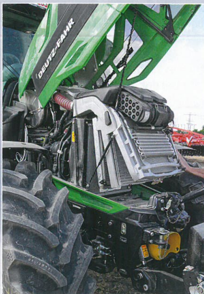
Das Kühlerpaket ist komplett überarbeitet und der Viscolüfter jetzt elektronisch geregelt. Deutz-Fahr verspricht mindestens 5 % weniger Verbrauch.
