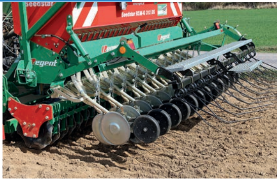
Schareinheit und Striegel lassen sich hydraulisch ausheben.
