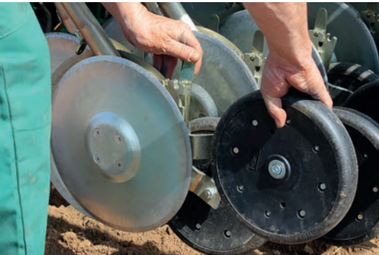
Die Doppelscheibenscharre samt Andruckrollen gefielen uns im Test sehr gut.
