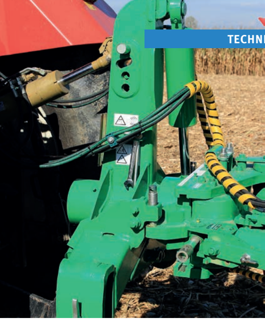
Im Drehwerk hatte unser Testpflug die größere Achse mit 130 mm Durchmesser eingebaut.
