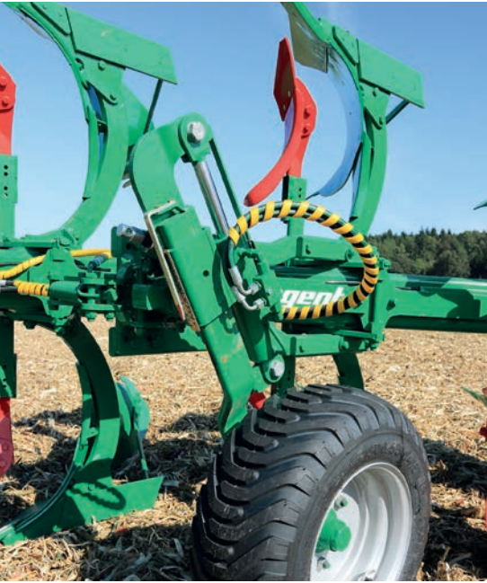
Das Pendelstützrad (und damit die Arbeitstiefe) ist von der Kabine aus verstellbar.
