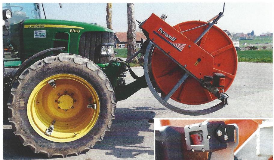
Für «hohe» Frontanbaugeräte bietet Remund + Berger eine Montage-Variante seitlich des Gerätes an.
