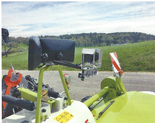
«Blaser-Visio-QVK»: Bei dieser Anbau-Variante sind die Kameras direkt auf dem bestehenden Doppelspiegelhalter montiert.
