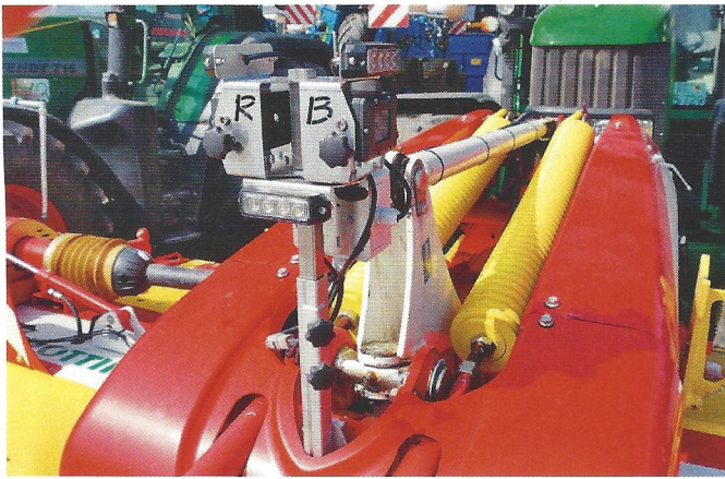
Das Vorbau-Kamera-Monitor-System VKMS (Motec) mit Blinklicht, aufgebaut auf einem Schnellwechselsystem von Remund + Berger.
