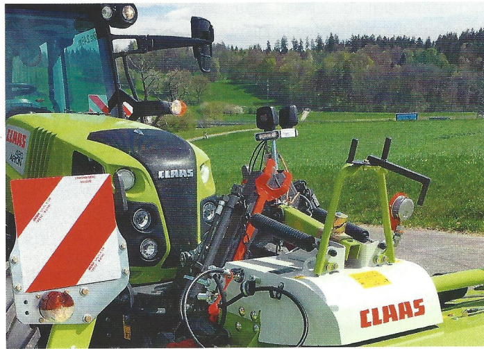
Hier ist das Kamera-System «Blaser-Visio-QVK» in Kombination mit einem Blinklicht auf dem Anbaubock montiert.
