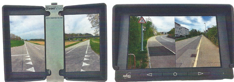
Beim Kamera-Monitor-System von Blaser kann zwischen einem gesplitteten 7-Zoll-Monitor oder der Kombination von zwei 7-Zoll-Monitoren gewählt werden.
