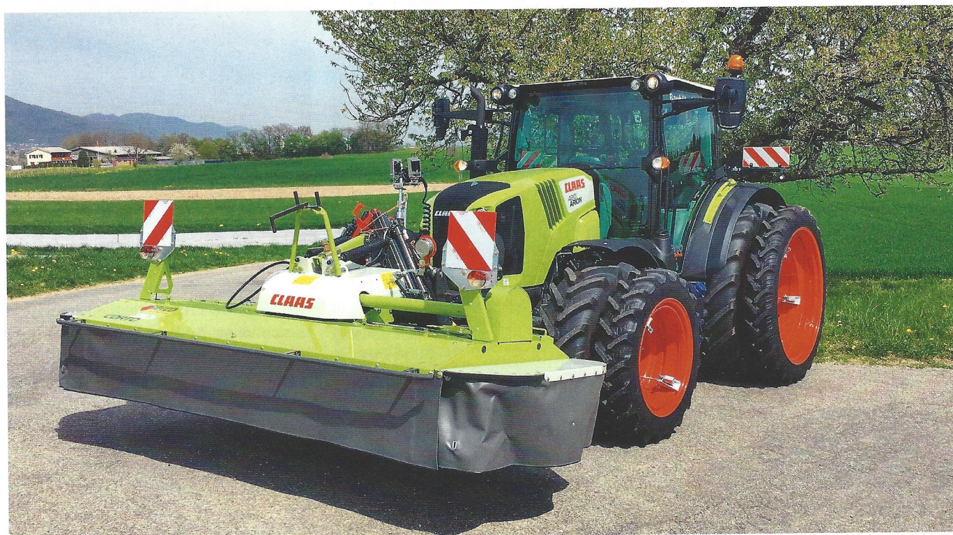
Bei einem vorderen Überhang von mehr als 4 m ist ein in der Schweiz zugelassenes Kamera-Monitor-System Pflicht. Bilder: zvg/H. Röthlisberger
